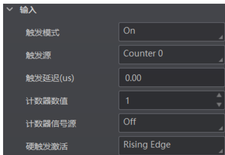
图3-44 计数器触发参数设置
