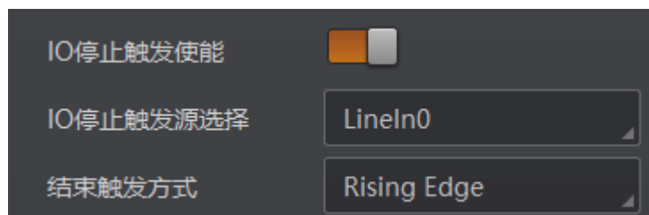
图3-52 I/O 外触发停止
