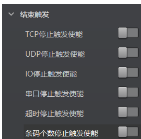
图3-49 停止触发使能
