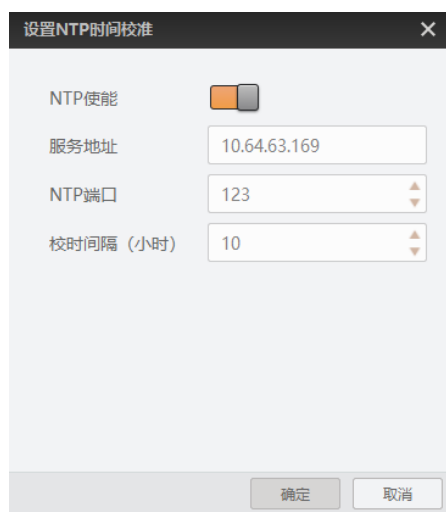
图3-84 NTP 时间校准设置
