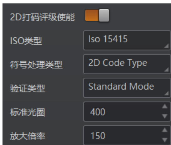
图3-36 Type2 打码评级参数设置
